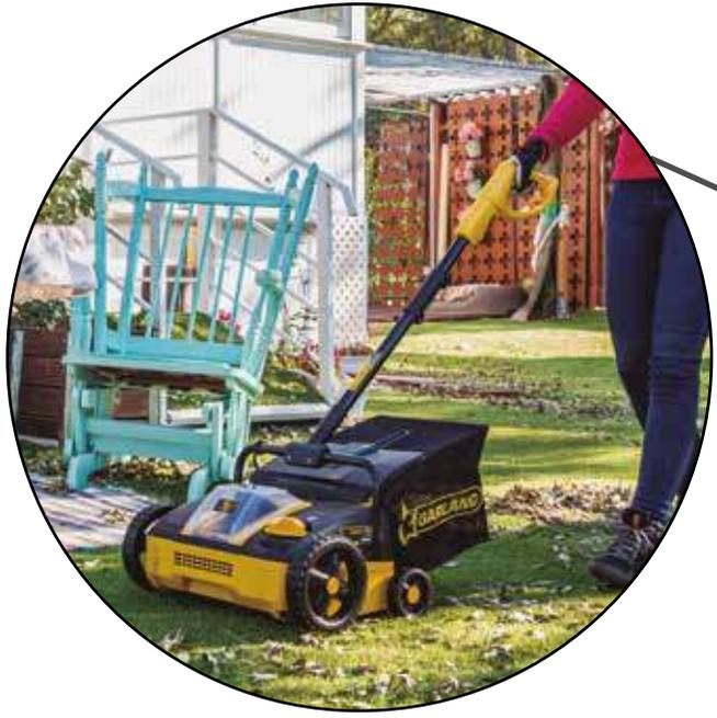
Accede a todos los rincones y levanta las fibras para recuperar el volumen del césped, recogiendo en su saco de tela la suciedad que levanta de entre el césped
