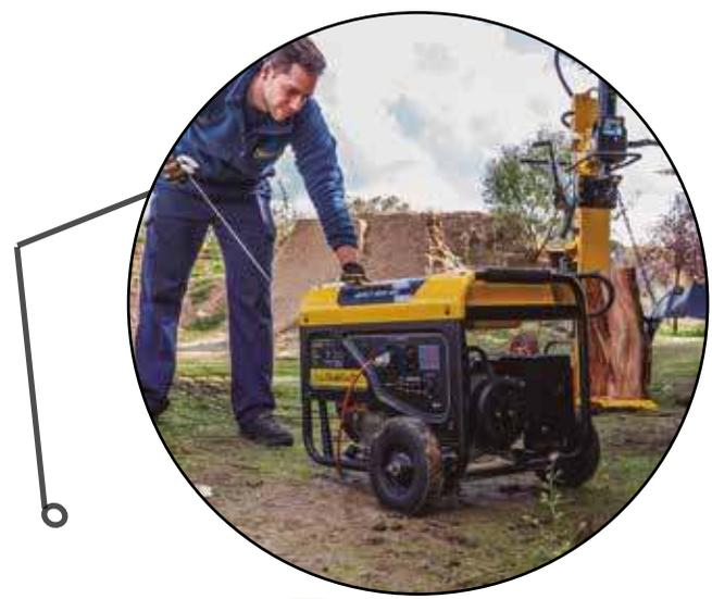
Incorpora una pantalla digital con información de voltaje, frecuencia y horas de uso, para un mejor control de su funcionamiento
