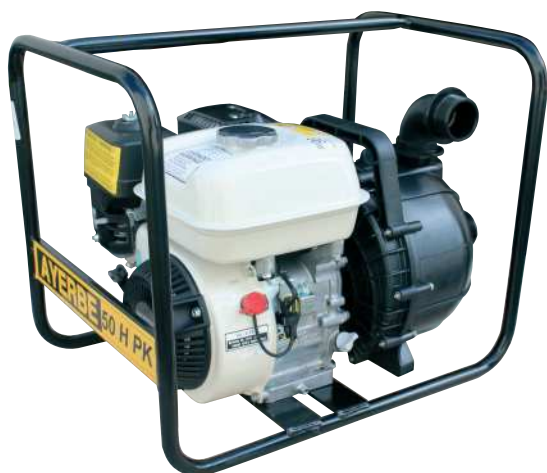
Bomba autoaspirante con el cuerpo, turbina, difusor en POLIPROPILENO. Tornillería en acero inoxidable. Sello mecánico y juntas resistentes a líquidos abrasivos y corrosivos.
